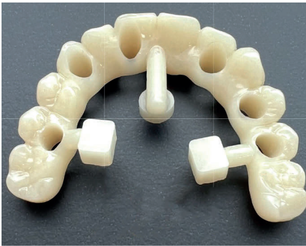
Ryc. 30 Szczeka - most tymczasowy wyfrezowany z PMMA uchwytami do stabilizacji na szablonie master
